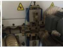
Hava Üfleme Kazıma Air-Blown Scraping
