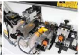
Freze Ünitesi, Radüs Kazıma ve Polisaj Ünitesi Milling, Scraping and Buffing Unit
