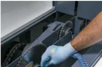
Pnömatik takım değişim sistemi sayesinde testere değişimi çok kısa bir süre de gerçekleşir.
