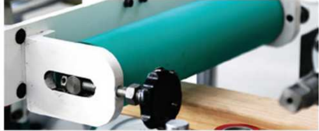
Tutkallanmış Malzemeyi Kesişim Noktasında Hizalayan Baskı Mardanesi The Pres Rolls Is Ailing Glued Material in Intersection Point
