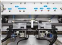
Lineer taşıyıcı testere ünitesi Linearly Moving Saw Unit
