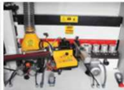
Ön freze , ön ısıtıcı, tutkallama ve baskı ünitesi Pre milling, Pre heater, Glue and pressure unit
