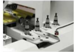
4'lü Otomatik Takım Tutucu 4 pcs Automatic Tool Holder
