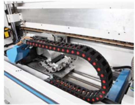
Robotik rounder (köşe yuvarlama) ünitesi Rounder Unit
