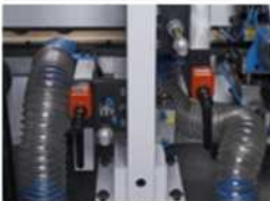
Servo kontrollü radyüs kazıma ünitesi Radius Scrapper Unit
