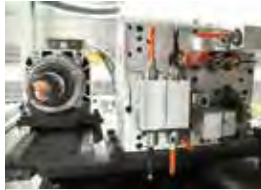
7,5 kw Freze Motor Gücü (SMART) 7,5 kw Spindle Motor Power
