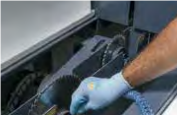
Pnömatik takım değiştirme sistemi sayesinde testere değişimi çok kısa bir süre de gerçekleşir.
