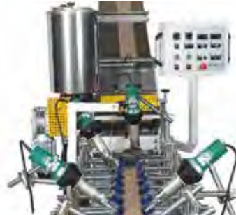
Tutkallanmış Malzemenin Ürüne Yapıştırıcılığını Artıran Sıcak Hava Tabancaları The Hot Air Duster Guns is Increased the Adhesion of Glued Materials to the Product
