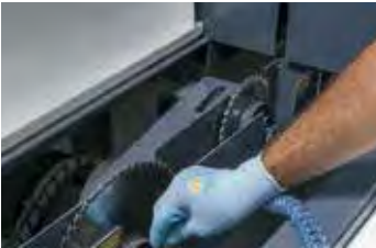
Pnömatik takım değişirme sistemi sayesinde testere değişimi çok kısa bir süre de gerçekleşir.
