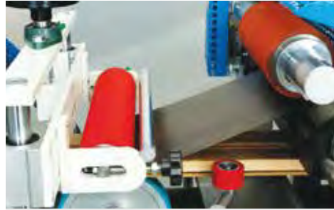
Tutkallanmış Malzemeyi Kesişim Noktasında Hizalayan Baskı Merdanesi The Pres Rolls Is Ailing Glued Material in Intersection Point
